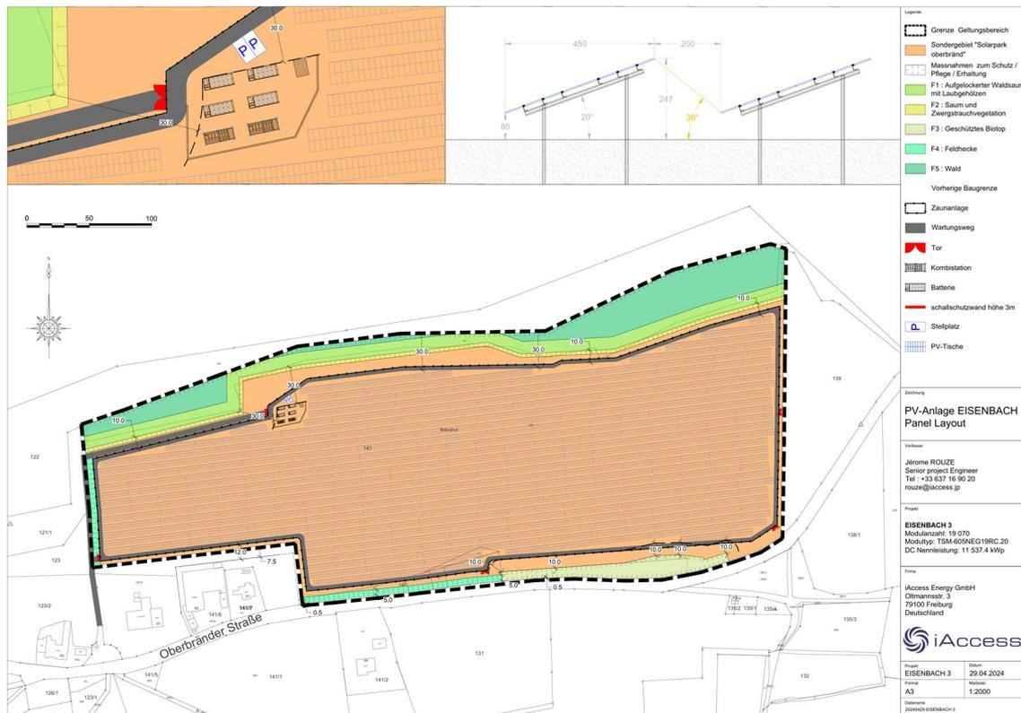
Abb. 17: PV-Layout der geplanten Photovoltaikanlage
